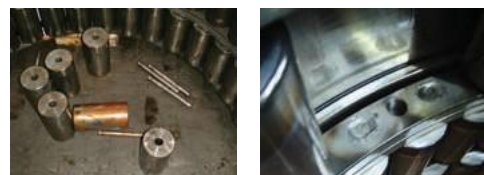
(四列圆柱滚子轴承的外圈组件) (四列圆柱滚子轴承的外圈组件)
