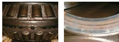
(双列圆锥滚子轴承的内圈组件) (双列圆锥滚子轴承的外圈)
